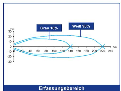
Der sichtbare Rotlicht Laser erlaubt selbst die präzise Erfassung von sehr kleinen Objekten. Neben Tastweiten bis zu 60 cm kann der Sensor auch für die Erfassung von Druckmarken mit gutem Kontrast eingesetzt werden, wobei die Laserschutzklasse 1, entsprechend der EN 60825-1, dem Bediener bei allen Anwendungen stets ein Maximum an Sicherheit garantiert.
