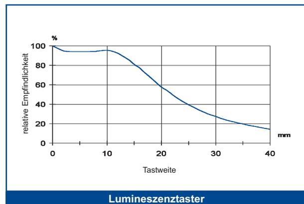
Dieser Sensor gibt proportional zu der Entfernung, eines sich innerhalb des Messfeld befindlichen Objekt, ein Analogsignal von 0-10Vdc aus. Eine gelbe Anzeigen-LED signalisiert den Status des NO Ausgang (normally open), dessen Schaltschwelle durch einfachen Tastendruck gespeichert wird. Befindet sich das Messobjekt außerhalb des Messfeldes, wird dies mittels einer roten LED signalisiert.
