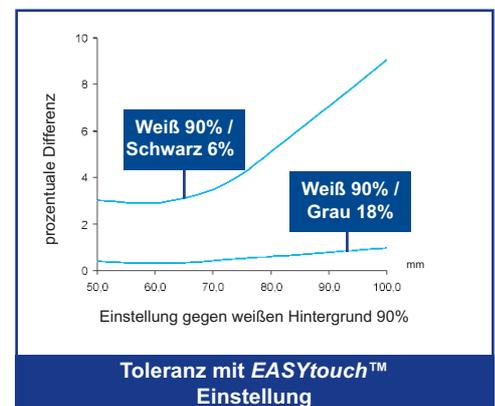
Reflexaster mit Vorder- und Hintergrundausbldung erlauben die exakte Einstellung der Tastebene. Objekte die sich hinter oder vor dieser Tastebene befinden werden nicht erfaßt. Die **EASYtouch™** Teach-In-Einstellung passt sich automatisch den Gegebenheiten an und wird durch einfachen Tastendruck aktiviert.
