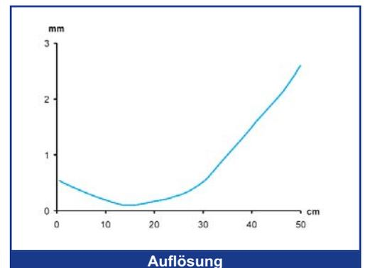
Reflextaster mit Hintergrundausbuchtung erlauben die exakte Einstellung der Tastebene. Objekte die sich dahinter befinden werden nicht erfaßt. Die *EASYtouch™* Teach-In-Einstellung passt sich automatisch den Gegebenheiten an und wird durch einfachen Tastendruck aktiviert.
