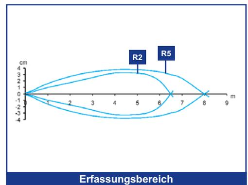
Reflexlichtschranken mit sichtbarem Laserlicht ermöglichen eine große Reichweite. Unter Verwendung vom speziellen Reflektoren mit 0.8 mm Mikroprismen (R7/R8) lassen sich selbst Erfassungsaufgaben für sehr kleine Objekte realisieren. Die Laserschutzklasse 1, entsprechend der EN 60825-1, garantiert dem Bediener in allen Anwendungen stets ein Maximum an Sicherheit.
